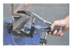
D'une longueur de 270 mm, permettant une ouverture de plus de 130 mm, la BXL 276 offre un serrage et déverrouillage faciles, d'une seule et même main.
